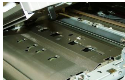
La entrada del registro endereza el papel y posteriormente desciende conforme la página avanza hacia el sensor de imagen de contacto para la realización de ajustes adicionales.
