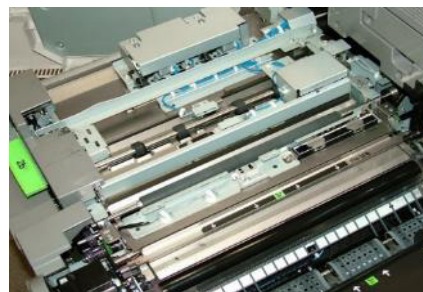
El transporte del alineador facilita el registro del papel a +/-0,5 mm.
